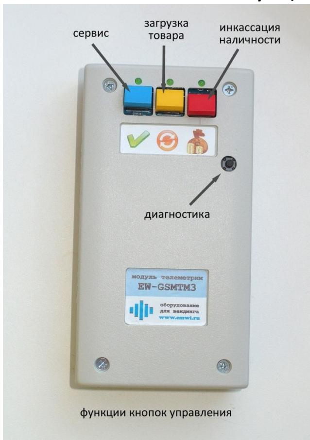
**Кнопки обслуживания** – группа из 3 кнопок с индикатором у каждой из них, используется для сброса счетчиков и передачи уведомления, что аппарат был обслужен. После нажатия любой из кнопок в течение 5 секунд соответствующий индикатор мигает, и можно нажать другие кнопки обслуживания. После истечения данного интервала раздается звуковой сигнал, индикаторы перестают мигать и осуществляется обработка нажатия.
